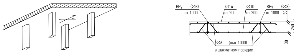
Рисунок 5.7 Принятая схема и поперечное сечение безбалочного железобетонного перекрытия, работающего в двух направлениях
